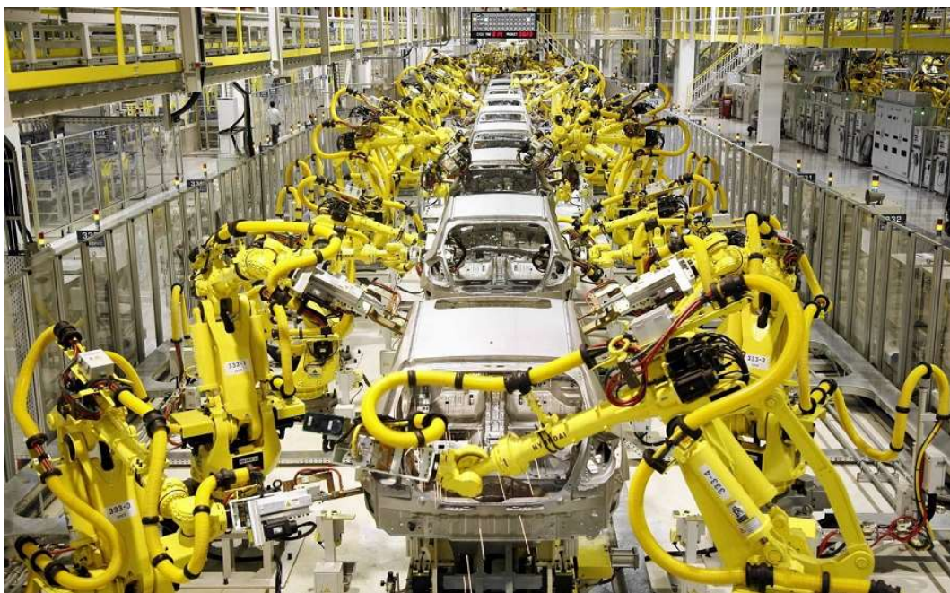
Robotska linija za montažu
