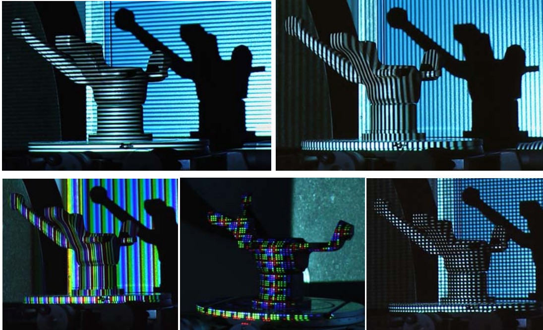
Слика 8: Фотографије експерименталне инсталације за оптичку триангулацију структуриране светлости за екстремно брзу аквизицију просторне геометрије окружења: а) експериментална опрема развијена кроз самоградњу (етапа 1) и б) фотографије пробних испитивања развијеног система за кодирање светлосног извора.
