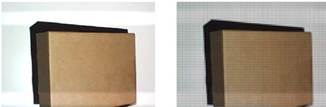
Слика 2.3.6: Поређење оригиналне фотографије сцене са призмом (лево) и ортогоналне пројекције генерисаног просторног модела приказаног на слици 2.3.5.
