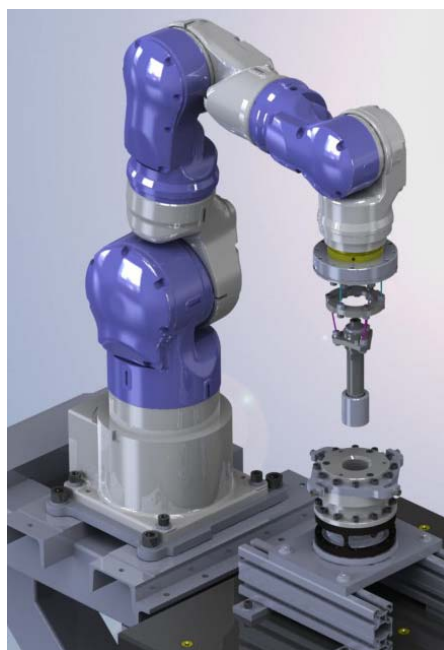
Слика 19: Експериментална инсталација #2: Роботски систем базиран на YASKAWA SIA 10F роботу, специјализован за монтажу малих механичких склоповаса функцијом адаптивног понашања базираног на аквизицији генерализованог вектора силе спајања.
