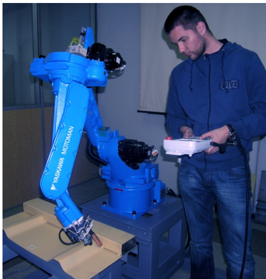
Слика 17: Експериментална инсталација #1: Базирана на роботу YASKAWA MA1400 и специјализована за монтажу заварених склопова / роботско заваривање, дигитализацију геометрије завареног склопа и димензиону метрологију ласерском триангулацијом и триангулацијом структуриране светлости. Детаљи из фазе израде носеће структуре и финални изглед система са којим су спроведене експерименталне пробе у оквиру CyberFABRICATOR платформе (слика 10).
