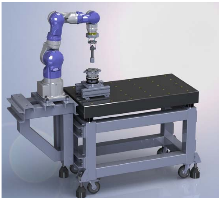
Слика 19: Експериментална инсталација #2: Роботски систем базиран на YASKAWA SIA 10F роботу, специјализован за монтажу малих механичких склоповаса функцијом адаптивног понашања базираног на аквизицији генерализованог вектора силе спајања.
