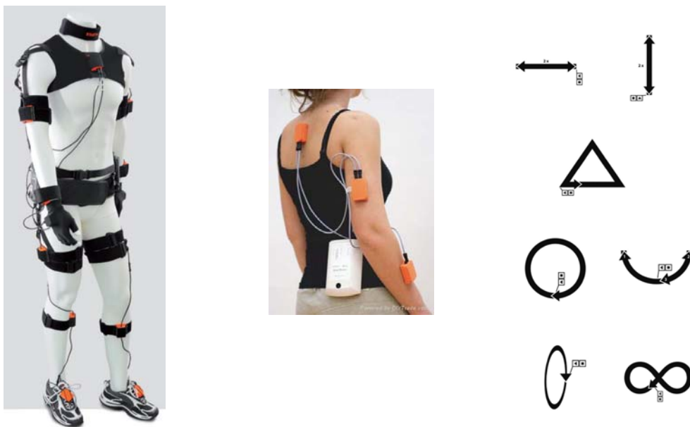
Слика 3: Концепт аквизиције понашања човека у извршавању конкретних радних задатака у индустријској производњи (лево) и пример азбуке за гестуалну комуникацију покретима између човека и робота (сензор интегрисан у рукав или у облику рукавице или наруквице може да генерише довољно информација за довољно дискриминативне временске секвенце које се могу препознати као слова наведене азбуке).
