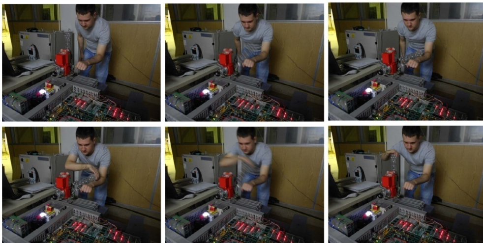
Слика 2: Практични експерименти колизије меког зглоба и људског тела – базна истраживања безбедне и психолошки прихватљиве физичке интеракције индустријског хуманоида и човека у контексту колаборативног и/или тимског извршавања радних задатака.
